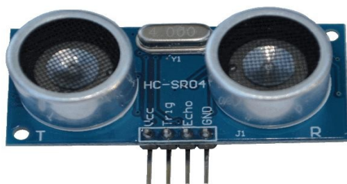
Εικόνα 20 – Αισθητήρας υπερήχων HC-SR04 (ultrasonic distance sensor)
